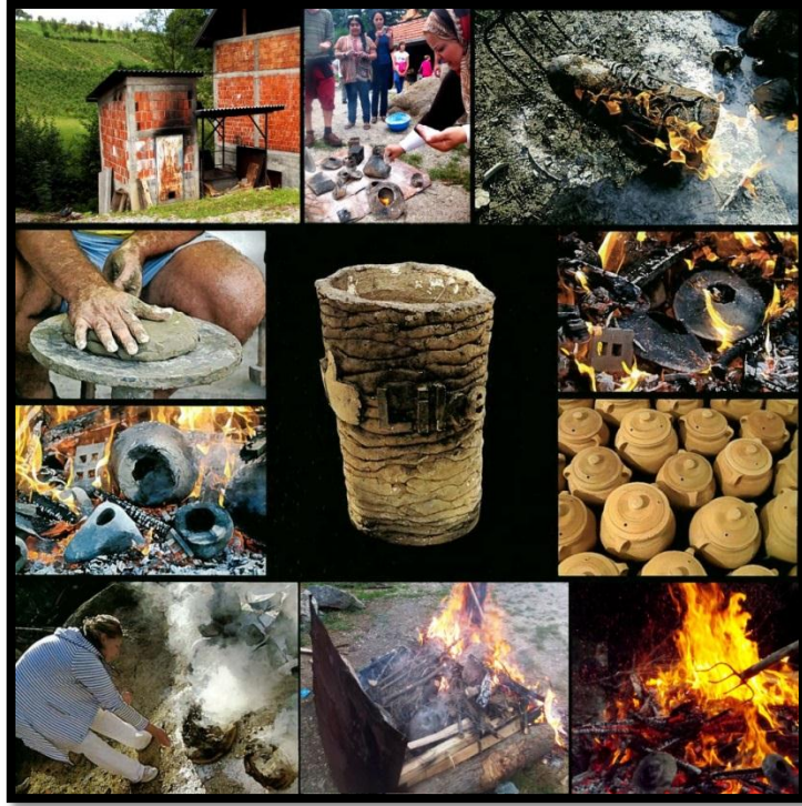
شكل رقم (٨) غرفة التجفيف قبل الحريق وطريقة الحريق المفتوح لمرة واحدة فقط
